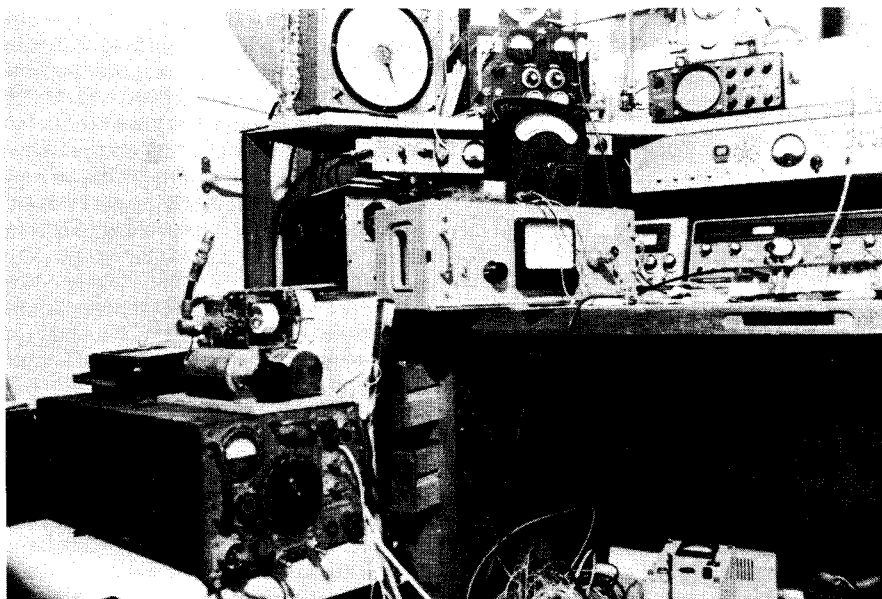
Meetopstelling, gebruikt bij het afregelen van de 13 cm convertor met op de voorgrond een ruisgenerator. Door een fout gaf deze aanvankelijk niet de juiste waarde. De 'doos' aan de linker kant is een dumpontvanger voor 1 tot 3 GHz, waarvan het oscillatorsignaal aanvankelijk werd gebruikt voor afregeldoelinden.
